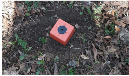
Fig. 2. Punct materializat cu borna de tip FENO (forma finală)
