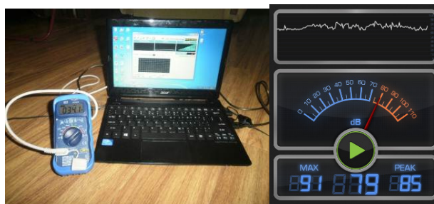
Fig. 2. Aparatul de măsura digital 4 în 1 PVE-222(stânga) și interfața aplicației Noise Meter(dreapta)
